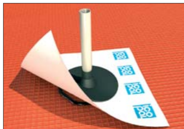
16. På alle mansjettene er det en gummiflens, denne skal tette mot membranen og det skal alltid være Fonda Fugemasse mellom gummien og membranen. Tapen er kun til for å holde mansjettene på plass. Det er membran, fugemasse og gummien på mansjettene som er det tettende sjikt.
