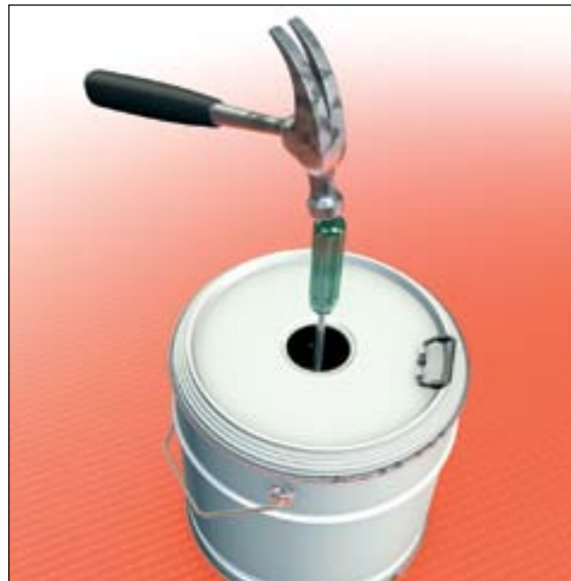
13. Slå et eller flere hull med en skrutrekker i topp-beholder slik at all herderen renner ned i hovedspannet.
