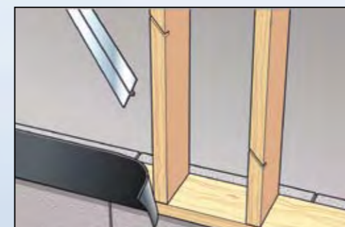
Icopal svillemembran gir en tett og fuksikker overgang mellom grunnmur og svill. Fås med én eller to vinger.
