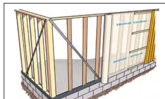
Med Windbreak etasjehøy vindsperre begrenses skjøtene til et minimum.
